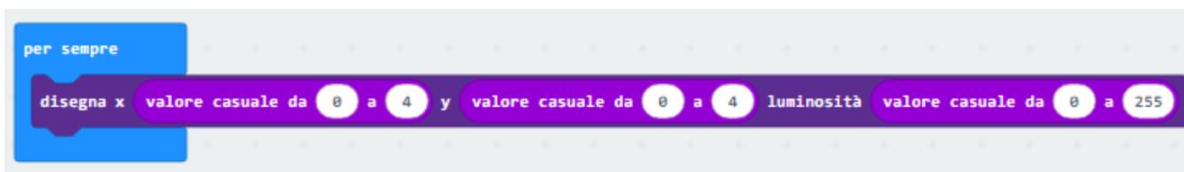
Nel blocco "per sempre" sostituiamo il blocco "disegna" precedentemente utilizzato con quello che prevede anche l'assegnazione di un valore alla luminosità del led.
